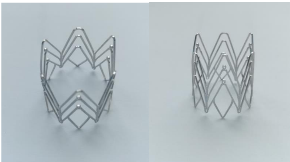
Рисунок 21 – Опорный каркас разработанного баллонорасширяемого протеза
